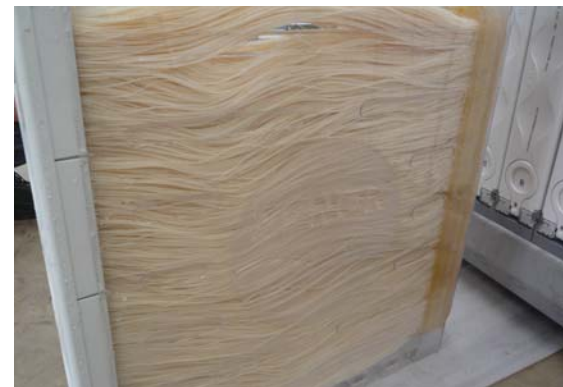
Figura 3. Detalle de un módulo de membrana UF
