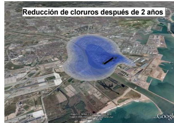
Figura 11. Impacto estimado de la barrera hidráulica en el acuífero del Llobregat a mayo de 2009. El mapa muestra las diferencias entre las concentraciones de cloruros de mayo de 2007 a mayo de 2009, indicando la mejora de la calidad del agua subterránea por la barrera
